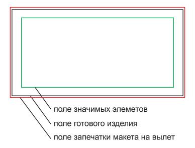
Макет на вылет для данной развертки - 92 мм х 47 мм. Готовый размер изделия - 90 мм х 45 мм. Поле значимых элементов - по 5 мм во внутрь от поля готового изделия (80 мм х 35 мм).
